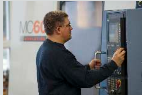
Bearbeitungszentrum Famup MC60 3 Achsen, mit IKZ 600x400x400 mm
