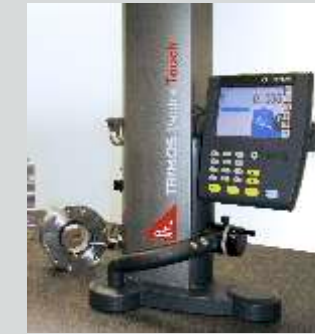
Messsystem TRIMOS Vectra Touch auf Mess- und Kontrollplatte • 2-Koordinaten-Messsystem (2D) mit höchster Genauigkeit • Erstellung eines kunden- spezifischen Protokolls • u.a. Flächen-, Durchmesser-, Achsabstandsmessung
