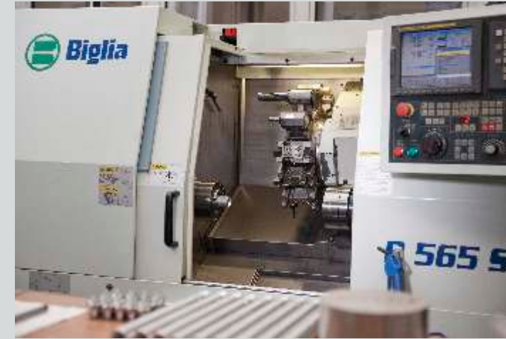
Drehmaschine Biglia B565 SM mit Gegenspindel, 3 Achsen, 12 angetriebenen Werkzeugen, mit IKZ und 65 mm Durchlass.
