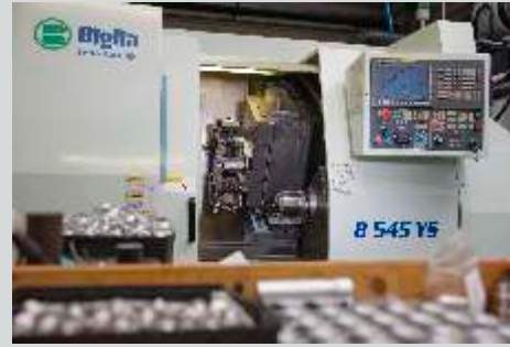
Drehmaschine Biglia B545YS mit Gegenspindel, 12 angetriebenen Werkzeugen, mit IKZ und 45 mm Durchlass.
